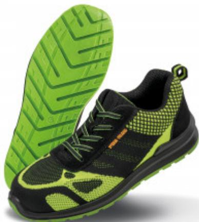
Tige: Polyester maille filet Flyknit avec bordure en daim. Semelle: Polyuréthane double densité. Respirant. Languette et encolure rembourrées. Talons absorbeurs de choc. SRA antidérapant. Semelle intérieure de rechange. Embout de protection en acier. Résistant à l'huile. Languettes arrières "chasse-pieds". CE EN 20345:2011 SB SRA.
